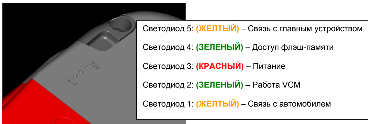
Рис. А. Расположение светодиодов под пластиковой крышкой
